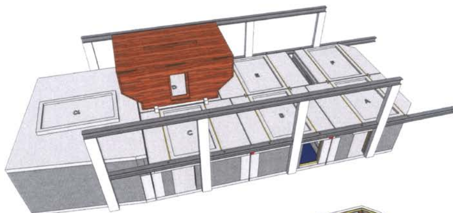
Illustration 3D du laboratoire acoustique, montrant le pont roulant, la cellule mobile M et les dalles de plafonds avec cuvettes en béton (les portes ne sont pas représentées).
